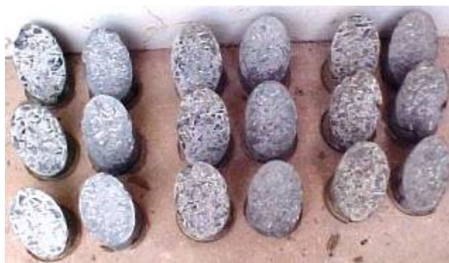
FIGURA 5: Espécimes adesivos industrializados, rompidos aos 3 dias, demonstrando ruptura na junta, especialmente entre o concreto do substrato e o adesivo.
