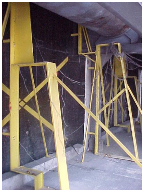
FIGURA 9 – Estrutura dos sensores de deslocamento linear
