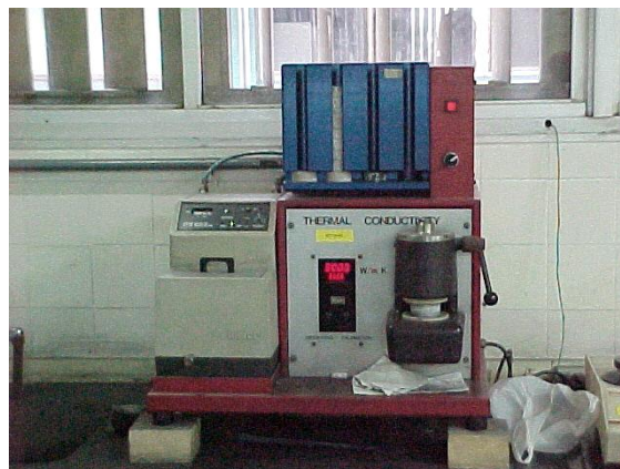
FIGURA 5 – Equipamento para medição da condutividade térmica do material
