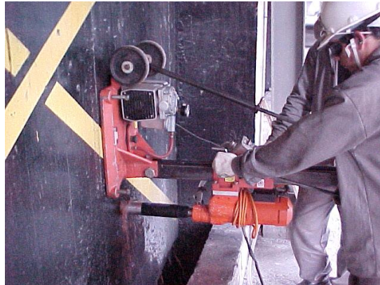
FIGURA 4 – Processo de retirada do testemunho para medição da condutividade térmica
