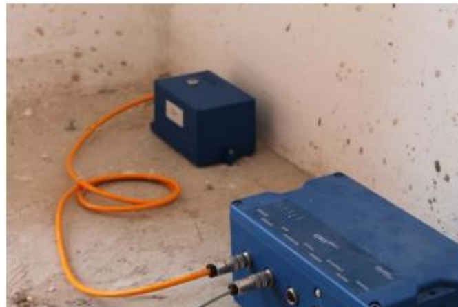
Figura 3 – Sistemas de aquisição modelo GeoSIG GMSPLUS conectados ao sistema ao acelerômetro eletromecânico
