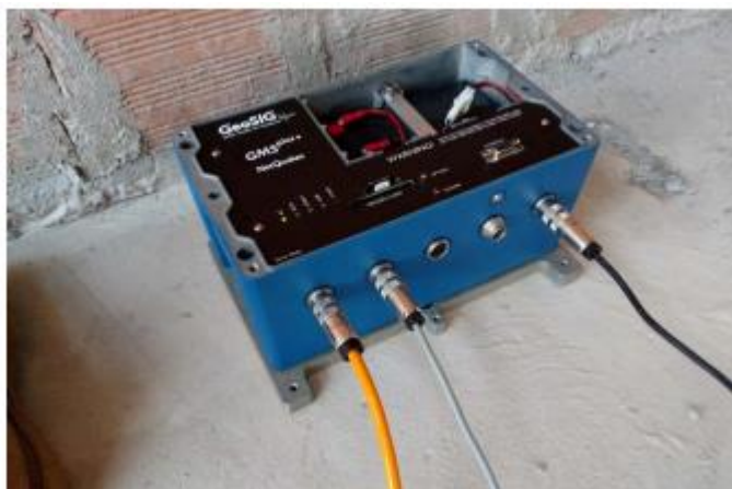
Figura 3 – Sistemas de aquisição modelo GeoSIG GMSPLUS conectados ao sistema ao acelerômetro eletromecânico
