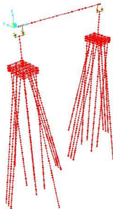
Figura 3 - Vista tridimensional do modelo de pórtico espacial adotado, extraído do trabalho de Lobato et al (2008).
