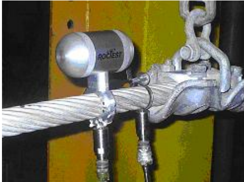
Figura 21 – Vibrógrafo Pavica sendo testado na bancada de vibração de cabos do Laboratório de Engenharia Civil da UFPA [31].
