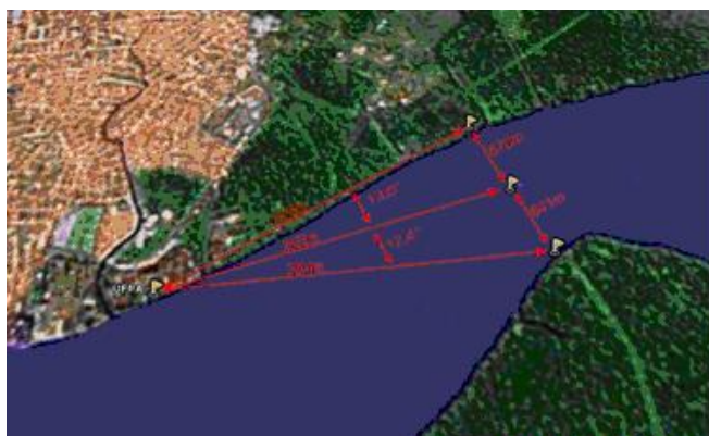
Figura 27 – Distância entre as antenas do sistema de comunicação.
