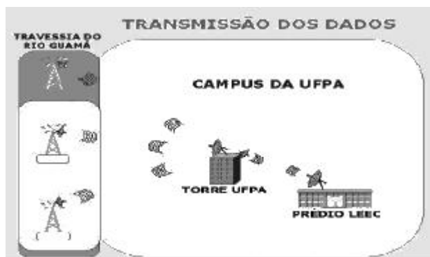
Figura 26 – Configuração do sistema de transmissão de dados sem fio.
