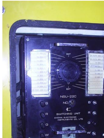
FIGURA 8: Multiplexador utilizado para leituras de extensômetros elétricos na UHE Tucuruí
