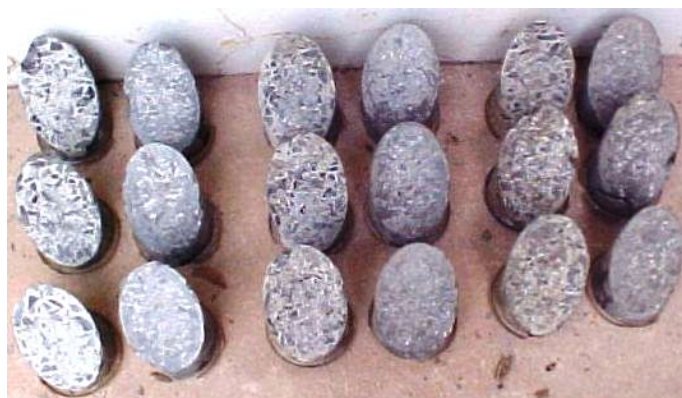
figura 6 – Espécimes dos dois adesivos epóxi e da resina polimérica, rompidos aos 3 dias, demonstrando ruptura na junta, especialmente entre o concreto do substrato e o adesivo.
